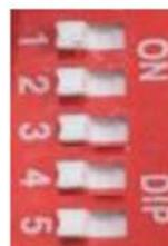
3 / Repositionne le sélectionneur n°3 sur OFF (à gauche)
